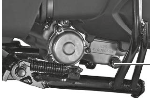
Vite di drenaggio (2)
