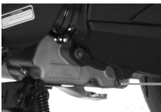
Vite di drenaggio (2)
