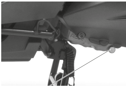
Vite di drenaggio (2)
