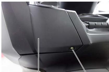
Coperchio batteria    Vite coperchio batteria
