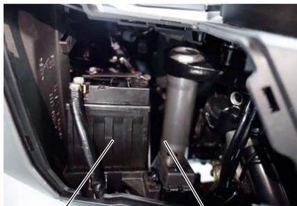
Batteria    Vano batteria
