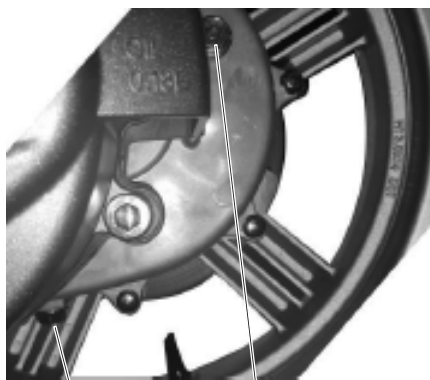
Vite di drenaggio (1)
